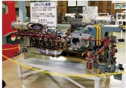
国鉄のディーゼルエンジンに正式採用 1955年にディーゼルエンジン用ガスケットが国鉄に純正指定された。1960年に登場したキハ80系特急形気動車に搭載されたDMH17H型エンジンにも石川ガスケットのガスケットが使用されている(北海道鉄道技術館)。
