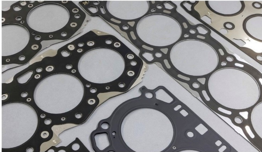
現在の直6ディーゼル用ガスケット。黒い部分は特殊な塗料をスクリーン印刷してある。変形したときの動きを吸収するため、やや硬めで耐摩耗性のいい塗料を使う。ステンレス材への印刷なので割れにくい塗料である。
